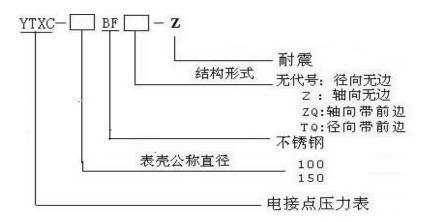
不锈钢耐震电接点压力表技术参数:
